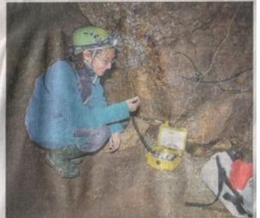
L'équipe dite de transmission est chargée, dans un secours, de communiquer avec l'extérieur, expliquer la situation et les besoins. Elle utilise pour cela un téléphone par sol. Cet appareil, très spécifique à la spéléologie, a été inventé pendant la Première Guerre mondiale pour détecter les Allemands qui creusaient des tunnels sous les tranchées. Le téléphone a deux antennes distantes d'une centaine de mètres qui créent un grand champ magnétique. Sur ce champ magnétique, l'équipe fait diffuser une fréquence. Ça permet de passer jusqu'à 400 mètres de roches. Photo Le Dauphiné Libéré
